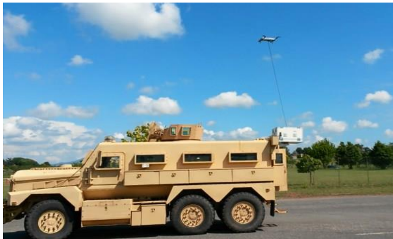
Resim 2. Araç Arkası Kablolu Drone Kullanımı (Hoverfly Case Study, 2020)
