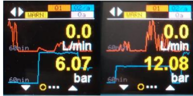
Şekil 3.1. Basınç Yükseltici Giriş-Çıkış Basınç Değerleri
