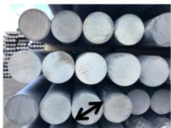
Çap ölçümü yapılan alüminyum kütükler ve çap değerleri
