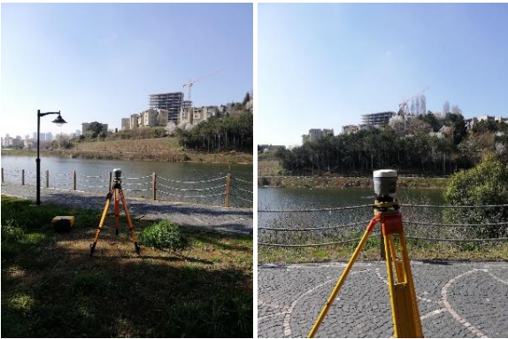
Şekil 3. Su Kıyısında Tesis Edilen Nokta Örnekleri
