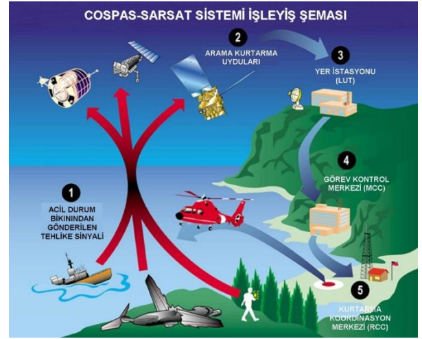
Şekil 8. Galileo SAR sisteminin işleyişi (URL-22)
