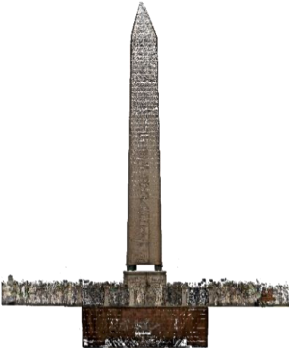
Şekil 5. Faro Scene ile elde edilen nokta bulutu
