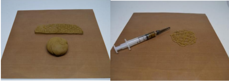
Görsel 4-5. Plastik ve Sıvı Kıvamda Metal Kili Örnekleri
