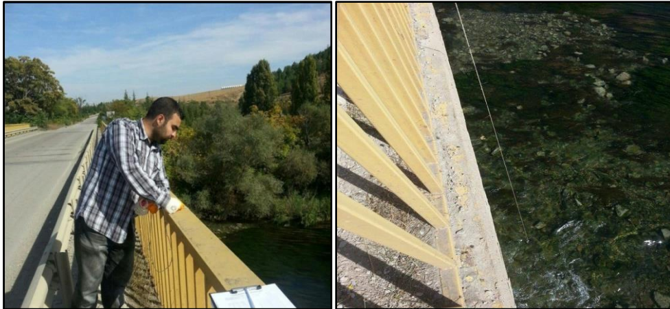
Şekil 8. Bahşılı karayolu köprüsü üzerinden yapılan batimetrik ölçümler
