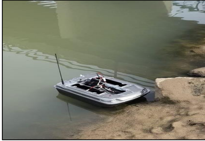
Şekil 6. Akustik sonar cihazının bağlı olduğu uzaktan kumandalı bot
