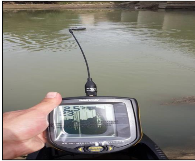
Şekil 7. Akustik sonar cihazı ile nehirde derinlik ölçümü
