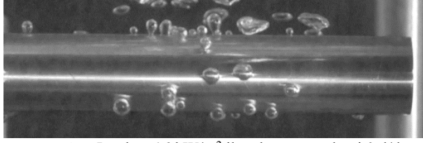
a) Isı akısı 16 \text{ kW/m}^2 iken karıştırıcı devri 0 d/d
