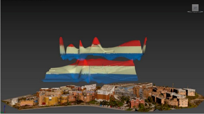
Şekil 6. Araştırma Sonucu İHA İle Elde Edilen CO 2 Emisyonunun 3D Ölçüm Haritası (Kaynak: Libelium, 2019, https://www.libelium.com/libeliumworld/success-stories/3d-air-quality-modeling-with-sensor-drones-in-greece/ , Erişim: 19.09.2020).
