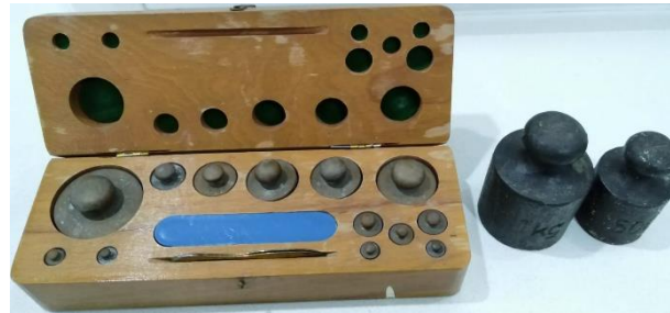
Şekil 4. Yük hücrelerinin kalibrasyonunda kullanılan kütleler
