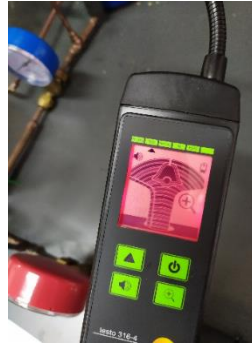
Şekil 7. Sistem oluşturulan yapay kaçağın dedektör yardımıyla tespiti
