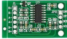
Şekil 5. Sinyal kuvvetlendirici, ADC, filtreleme ve arayüz işlevlerini gören HX711 kartı
