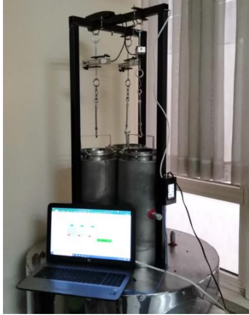
Şekil 5. Yük hücrelerinin kurutucu sistem üzerine bağlanması
