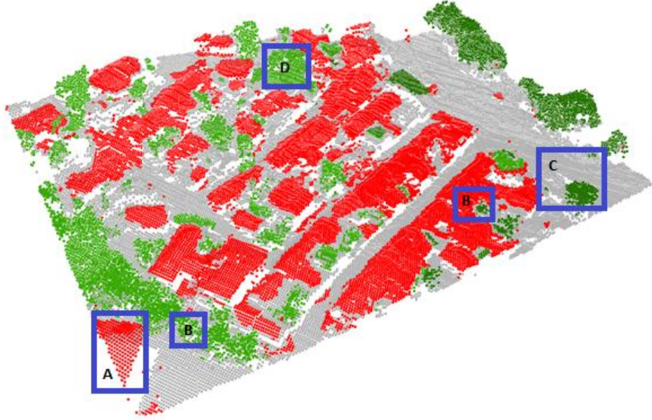
Şekil 8: KDH yöntemiyle sınıflandırılan zemin (gri), bina (kırmızı) ve bitki örtüsü (yeşil) noktaları
