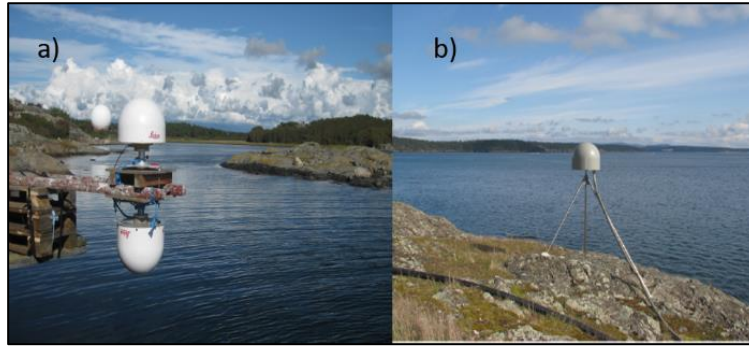
Şekil 2: GNSS-R jeodezik alıcıları. Soldaki (a) resim Onsala Uzay Gözlem Evine (GTGU) ait olup zenit (RHCP) ve nadir (LHCP) yönünde olmak üzere çift antene sahiptir. Sağdaki (b) resim ise Friday Liman GPS istasyonu (SC02) olup sadece zenit (RHCP) yönünde tek bir alıcıya sahiptir (Kaynak: (a) Johan Löfgren, Chalmers University of Technology, (b) UNAVCO (URL-2)).
