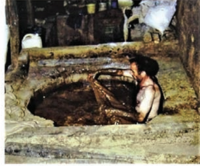
Fot. 14: Hazırlanan sama ile derilerin işlenmesi ve çukur içinde derilerin çiğnenmesi. Kahramanmaraş. (Dağtaş, 2007, 26)
