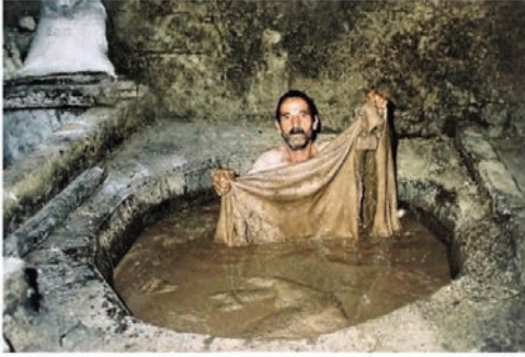
Fot. 14: Hazırlanan sama ile derilerin işlenmesi ve çukur içinde derilerin çiğnenmesi. Kahramanmaraş. (Dağtaş, 2007, 26)
