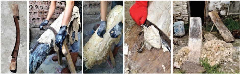
Fot. 12: Derilerin kavaleta tahtasına serilerek Kavaleta bıçağı ile etlerin sıyırılması, Bergama (Çınar ve Büyükyazıcı, 2017, 266)
