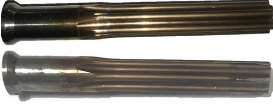
Şekil 4: TiSiN kaplı zımbanın ilk ve 514.500 delme işleminden sonraki görüntüsü.
