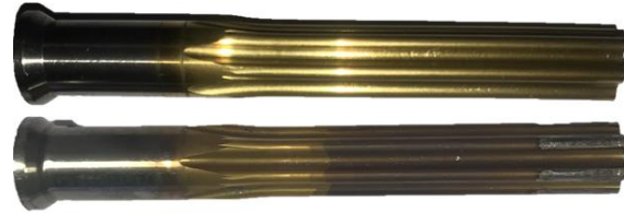
Şekil 8: TiN kaplı zımbanın ilk ve 514.500 delme işleminden sonraki görüntüsü.
