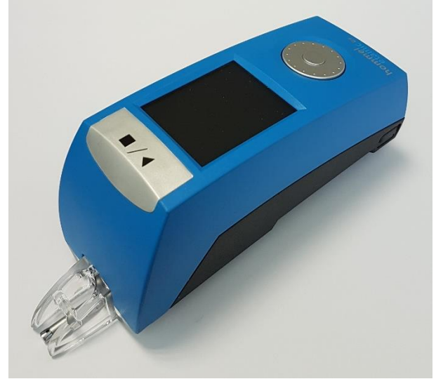
Şekil 6. JENOPTIK Hommel-Etamic W5 yüzey pürüzlülüğü ölçüm cihazı
