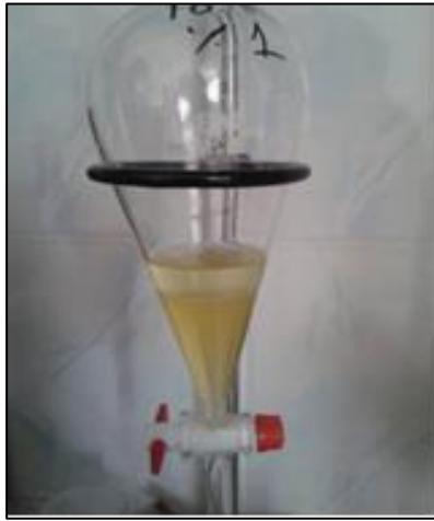
Şekil 2. Gliserin-biyodizel (ester) faz ayrımı
