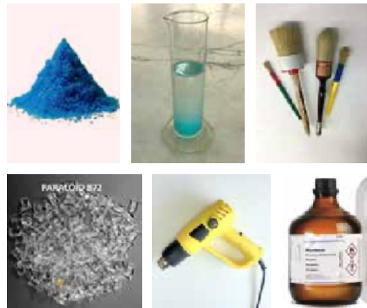
Resim 5. Deneyde kullanılan araç ve malzemeler. Bakır Nitrat Cu(NO3)2, kaynar su (saf), fırça (metal parça içermeyen), torç (gazlı veya elektrikli), saf aseton, paraloid veya parafin.
