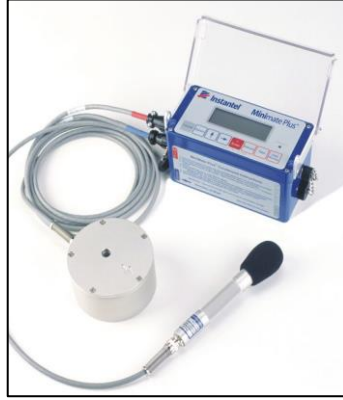
Şekil 7. Instantel Minimate Plus (Instantel)
