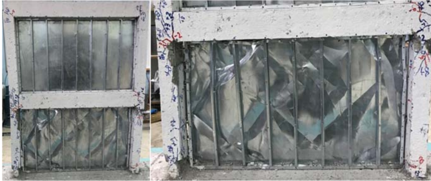
Şekil 9. Çelik sac levhalar çıkarıldıktan sonra D.N.3'ün görünümü (View of T.S.3 after removed steel sheets)
