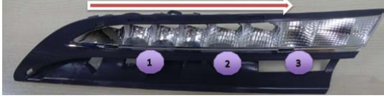
Şekil 19. Parça test ölçüm noktaları ve planet dönüş yönü (Part's test measurement points and revolution direction)
