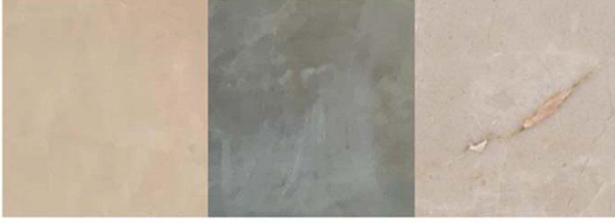
Şekil 3. Q4-C kalite sınıfına ait üç adet mermer levha görseli (Three marble slab images from Q4-C quality class)
