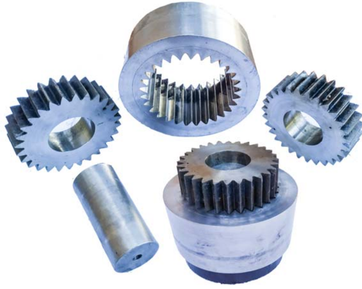
Şekil 5. Asimetrik Dişli Dövme Kalıp Seti (Asymmetric gear forging die set)
