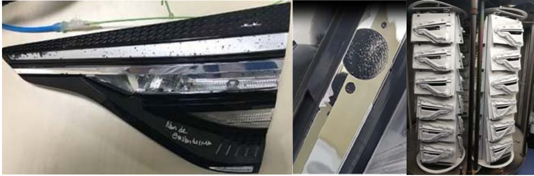
Şekil 2. Sırasıyla PV1200 termal test - NaOH testi sonrası bozulmuş parçalar ve çan içerisinde altlıkların konumlandırılması
