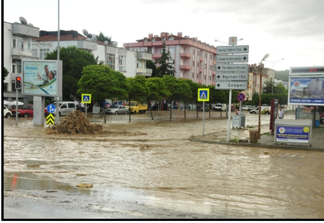
Foto 6. 2012 yılında Atakum'da meydana gelen selde sular (yükseltilmiş) sahil yolunu aşarak denize ulaşamadığı gibi rögorlardan geri basıyor.
