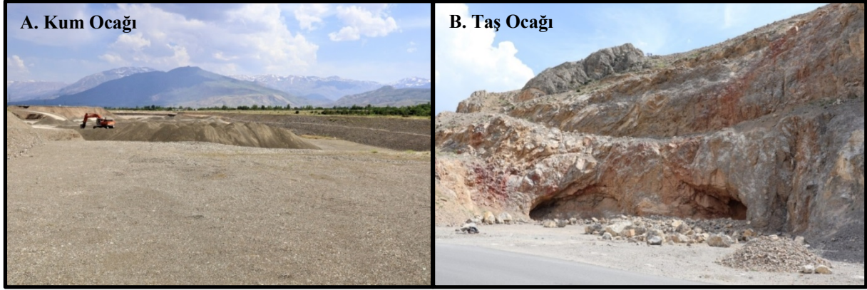
Fotoğraf 7. A: Büyük bir kısmını alüvyal dolguların oluşturduğu Erzincan Ovası içerisinde açık işletme şeklinde faaliyet gösteren kum ve çakıl ocakları çokça bulunmaktadır. B: Erzincan Ovası'nın güneybatısında Çatalarmut köyü yakınlarında işletilen taş ocağından çıkarılan patlatılmış malzeme hemen yakınında bulunan OSB'de kırma eleme tesislerine taşınarak kırmataş standartlarındaki tane boyutlarına kırma-elemeyle ayrılmakta ve mıcır, çakıl üretilmektedir (06.10.2020).
