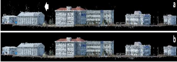
Şekil 5. Gürültülü (a) ve filtrelenmiş (b) Pix4d nokta bulutu verisi
