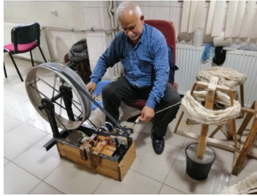
Fotoğraf 10: Tiftik Çilesinin Çıkrık Yardımıyla Masuraya Sarılması.
