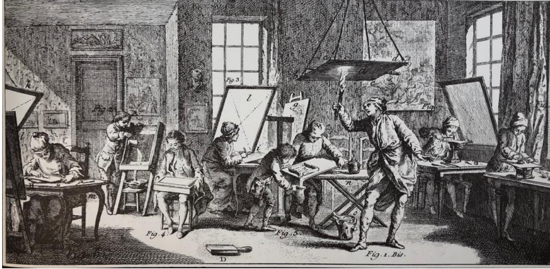
Resim 16 Bakır levhaların hazırlanması ve gravürlerin çizimi 54
