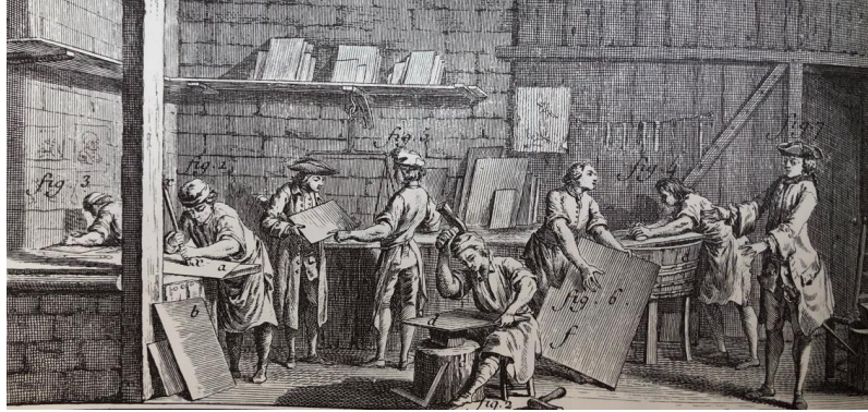
Resim 15 Bakır levhaların hazırlanması ve gravürlerin çizimi 53
