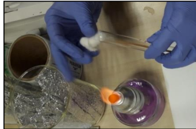
Resim 7. Tüplerin ağzının alevden geçirilme işlemi
