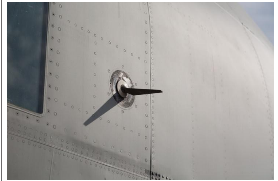
Şekil 3. Uçağın Her İki Tarafında Bulunan AoA Sensörü
