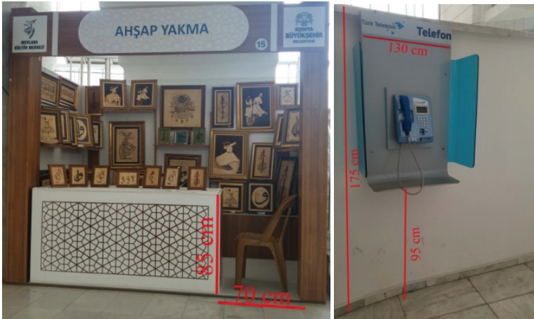
Şekil 41. H bloğa ait stant birimlerine ve telefon kulübesine erişim ölçüleri
