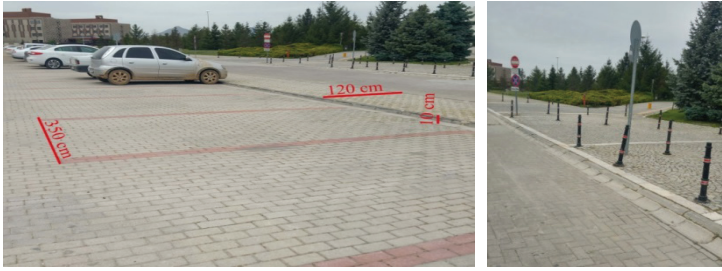
Şekil 16. Otopark ölçüleri ve uyarı levhaları
