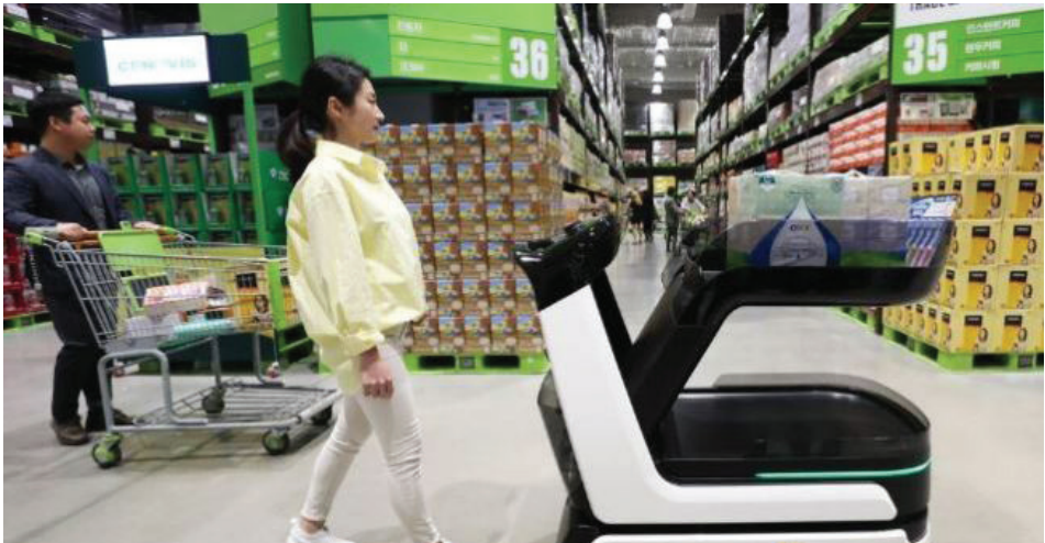
Şekil 5. Sürücüsüz ve temassız alışveriş sepeti (So-jeong, 2019'dan aktaran Arın Ensarioğlu, 2020).
