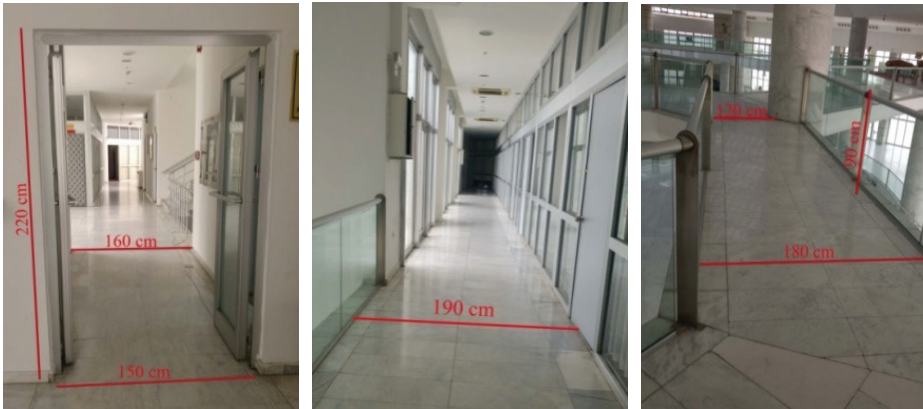
Şekil 35. Yapıya ait koridor düzenlemeleri ve boyutları
