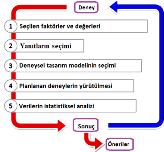
Şekil 1. Deney tasarımı modeli metodolojisine göre deney tasarımı (Jacyna vd, 2019'dan uyarlanmıştır)
