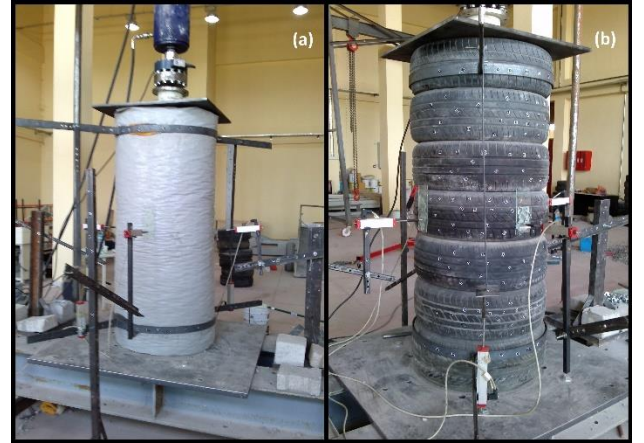
Şekil 2. (a) Polyester sarmallı (b) lastik sarmallı granüler kolon
