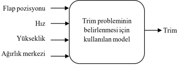
Şekil 2. Trim değerinin tahmini için kullanılan modellemenin blok gösterimi.
