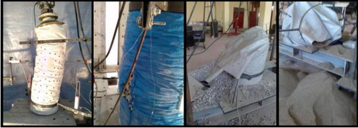
Şekil 8. Nihai yükleme anında polyester sarmallı granüler kolonlarda göçme anı
