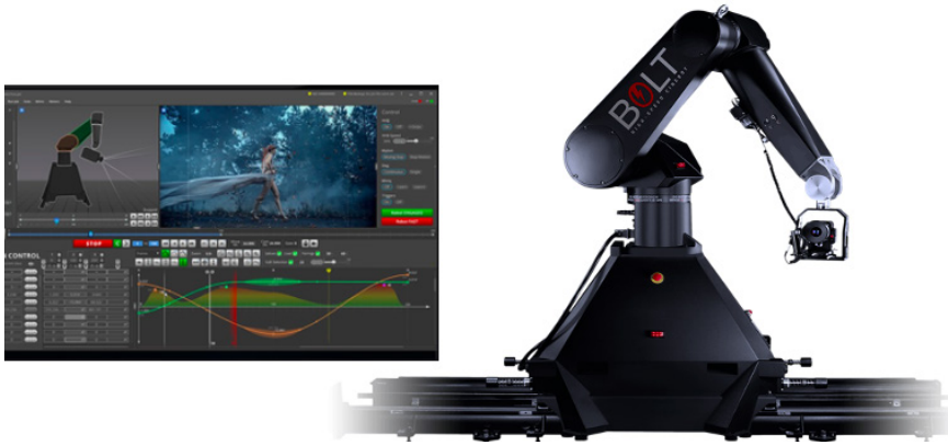
Resim 1: Mark Roberts Motion Control (MRMC) şirketinin ürettiği robot kamera kolu "Bolt" (URL-18).
