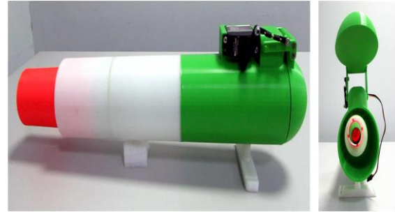
Şekil 9. Parçacık örnekleme modülünün yandan (kapak kapalı) ve önden (kapak açık) görüntüsü
