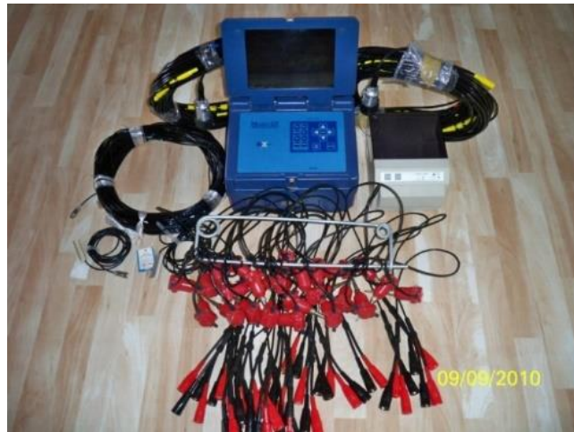
Şekil 7: Jeofizik çalışmada kullanılan sismik cihazın görünümü
