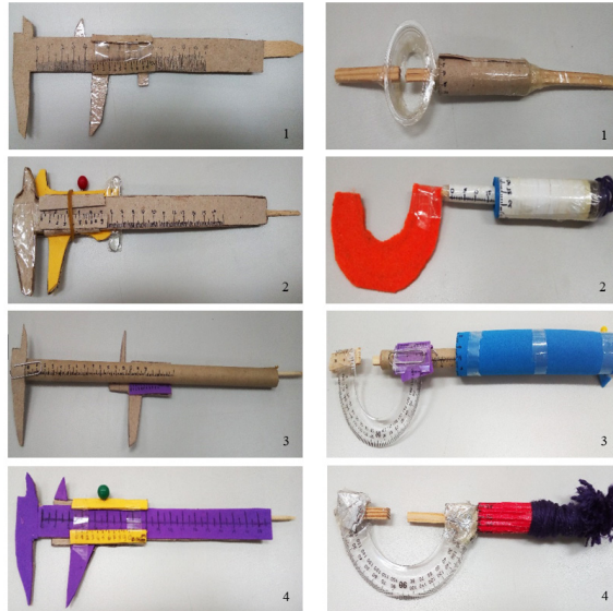
řekil 2. Grupların yaptıkları verniyerli kumpas ve mikrometreler
