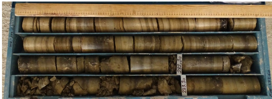
Şekil 10. Çalışma alanındaki eğimlenmiş marnlı seviyelerden görünüm (279,60-283,60 m)
