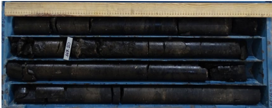
Şekil 14. Kömürlü birimleri içeren Miyo-Pliyosen yaşlı Güzelyayla formasyonuna ait karotların genel görünümü (166-170 m)
