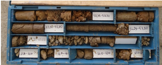
Şekil 13. Grabenin orta kesimlerinde yüzeylenen çakıllı-kumlu ve killi birimlerde kesilmiş olan karotların yakından görünümü (50,20-68,50 m)
