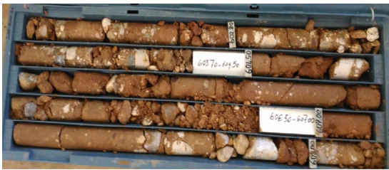
Şekil 15. Miyosen yaşlı Türkbekavak formasyonuna ait çakıllı çamurtaşı birimlerinin karot görünümü (602,20-608,10 m)
