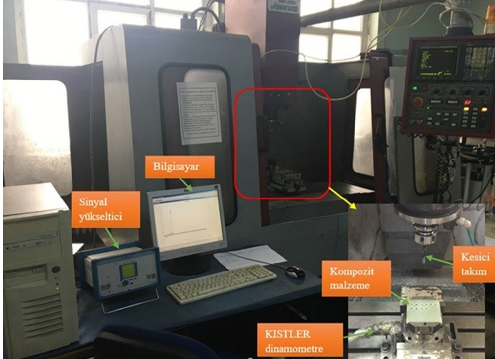
Şekil 2. Delme işleminde kullanılan deney düzeneği
