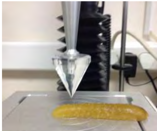
Şekil 2. Kornişon turşuda sertlik-tekstür analizi
