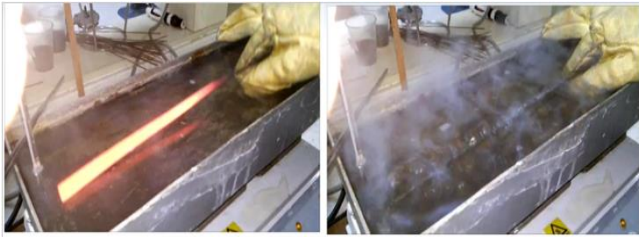
Şekil 3. 970°C deki telin 85°C deki su içerisindeki soğuma davranışı
