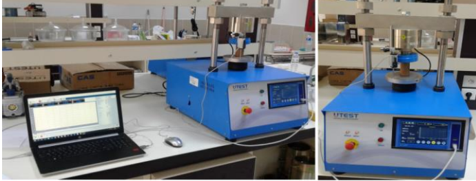
Şekil 2: Serbest Basınç Deneyi Seti
