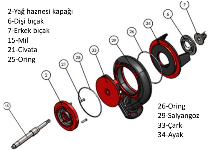
Şekil 5. CAD tasarımı yapılan parçalayıcı bıçaklı pompa patlatılmış resmi
