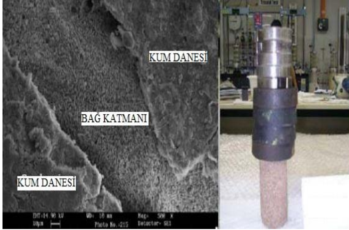
Şekil 20. Mikrobiyolojik Yapının Oluşturduğu Yapı ve Bu Yapının Laboratuvar Deneyi. (Mitchell ve Santamarina, 2005)
