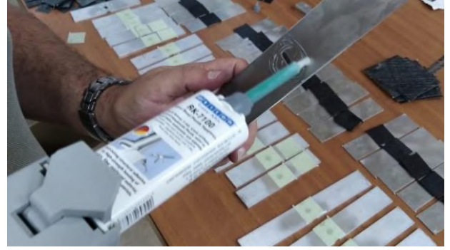
Şekil 4. Kompozit yamaların yapıştırılması.
