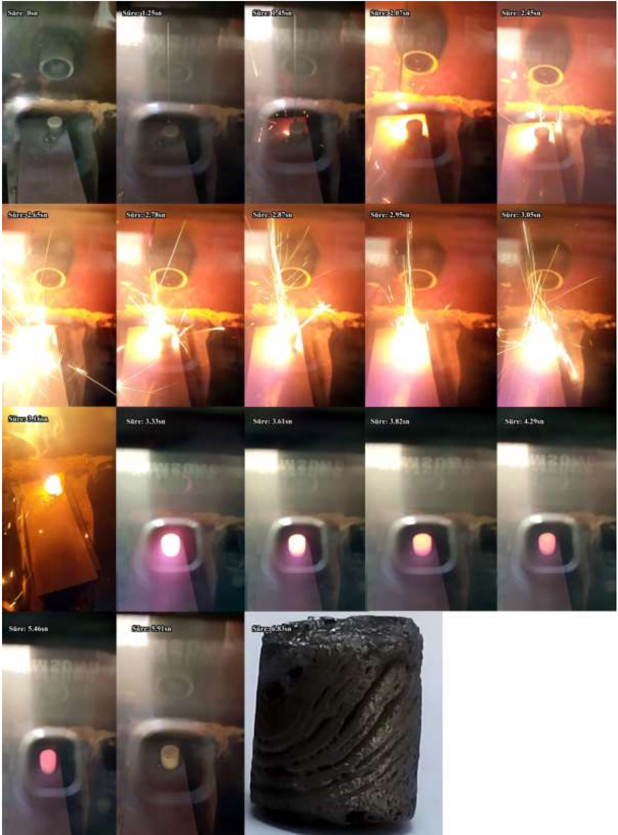
Şekil 3. ağ. %2 Al ilaveli numuneye ait yanma reaksiyonunun görüntüleri ve üretilen numuneye ait makro resim
