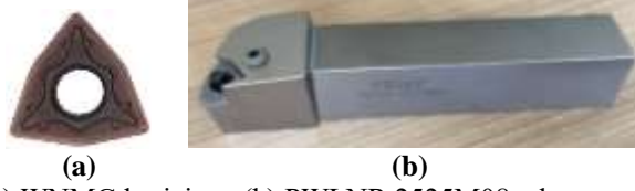
Şekil 2. (a) WNMG kesici uç, (b) PWLNR 2525M08 takım tutucu
