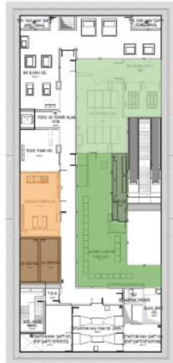
Şekil.14 Hoca Ahmet Yesevi İstasyonu Teknik Katta yakınlık ilişkisi bulunan mahallerin aynı renk tonları ile plan üzerinde gösterimi
