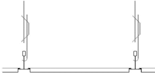
Şekil 7: Sarkmalı Plaka-Plaka Birleşim Örnek Kesiti (URL 1)
