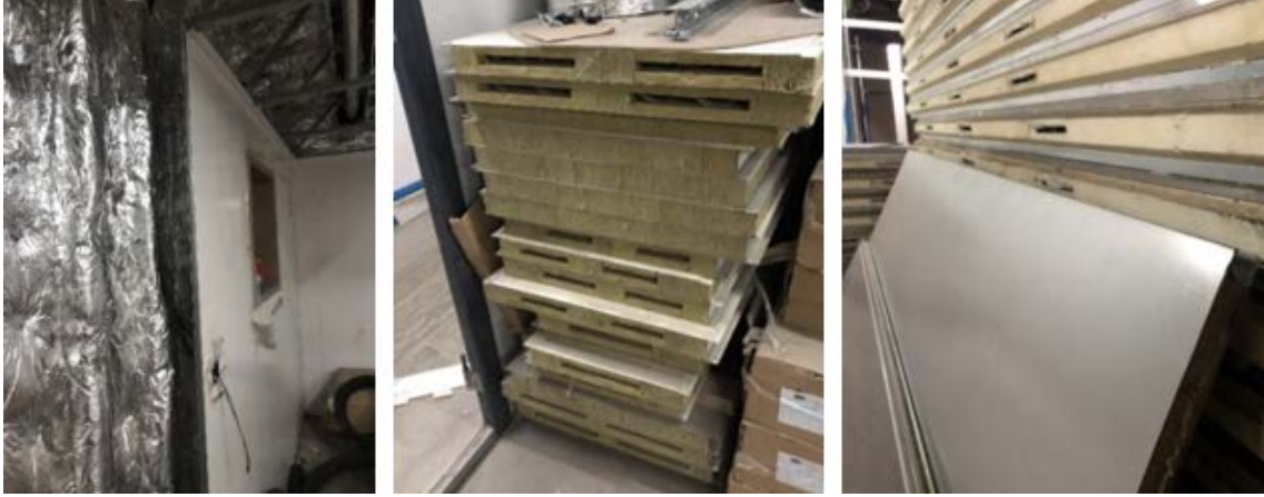
Şekil 4: Kuru alanlarda kullanılan galvaniz plakalı duvar panelleri (solda ve ortada), ıslak alanlarda kullanılan paslanmaz plakalı duvar panelleri (sağda), (Fotoğraflar: Yazar).
