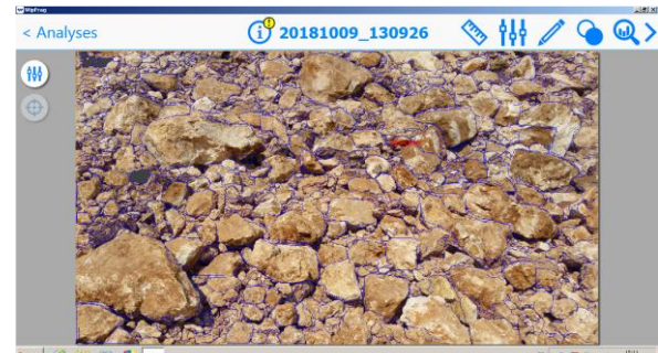
Şekil 7. Dinar ocağı taş tozu sıkılamalı atımın Wipfrag ile parça boyut analizi
