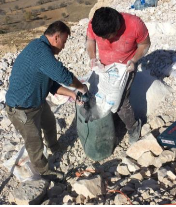
Şekil 3. Bozanönü kireçtaşı ocağı alçı sıkılama uygulaması
