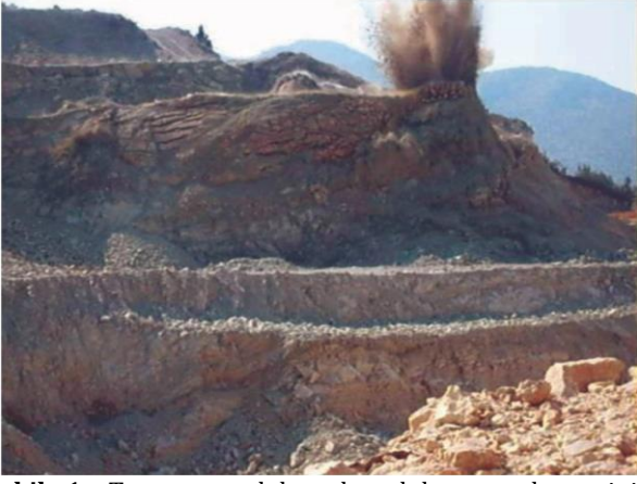
Şekil 1. Taş tozu sıkılamada sıkılama malzemesinin fıskırması [5].
