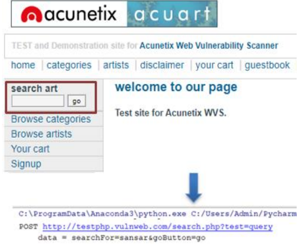
Şekil 12. FormScraper metodu tarafından POST isteklerinin üretilmesi
