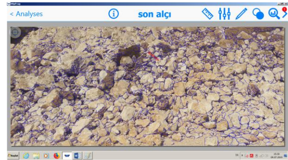
Şekil 8. Dinar ocağı alçı sıkılamalı atımın Wipfrag ile parça boyut analizi
