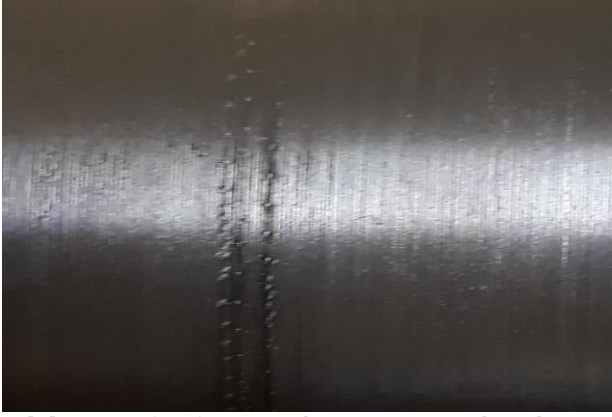
Şekil 3. SAE (AISI) 4140 çeliğinin 10000 noktasal temas sonucunda yüzey görünümü
