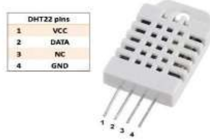
Şekil 3. DHT22 sensörü ve pin yapısı
