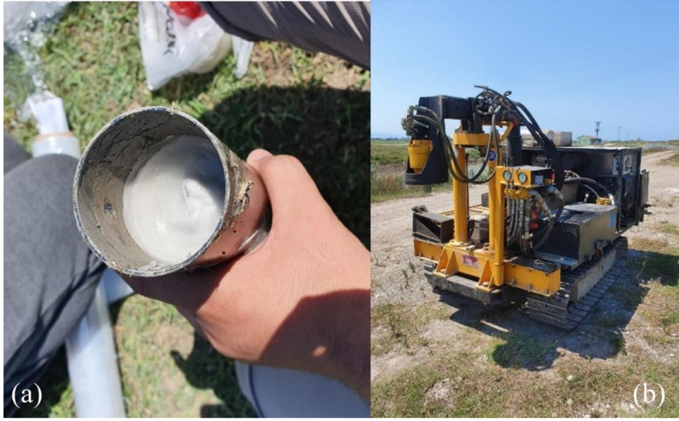
Şekil 2. (a) Alınan örselenmemiş zemin örneklerin parafınle kaplanması. (b) CPTu deneylerinde kullanılan Gouda® mobil CPT cihazı
