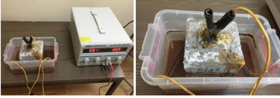
Şekil 3. Hızlandırılmış korozyon yöntemi uygulanan beton örneği
