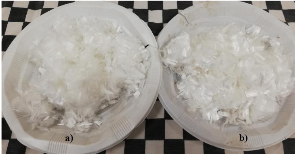
Şekil 2. Çalışmada kullanılan PP lif; a) 6 mm, b) 12 mm
