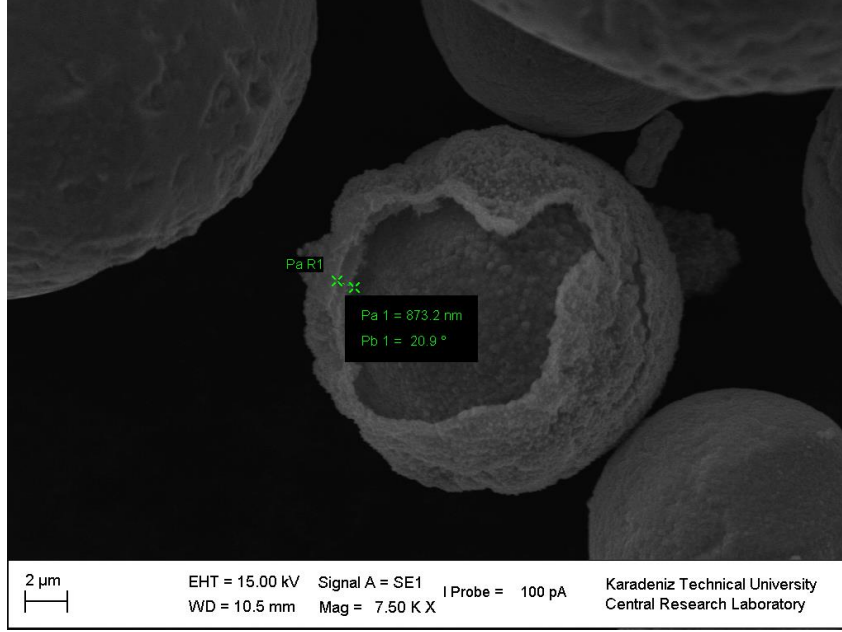
Şekil 8. D-1 kodlu bimetal parçacık gümüş kaplama tabakası kalınlığı.
