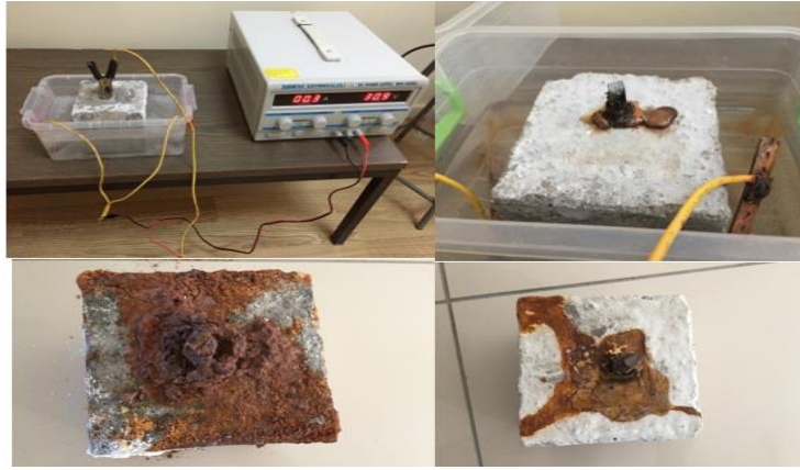
Şekil 19. Donatı çubuklarının korozyon oluşumları
