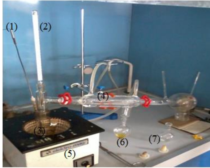
Şekil 2. Destilasyon düzeneği. (1. Destilasyon balonunda bulunan sıvı sıcaklığını ölçen ısıl çift, 2. Buharlaşan sıvı sıcaklığını ölçen ısıl çift, 3. Destilasyon balonu, 4. Su soğutmalı soğutucu, 5. Mantolu ısıtıcı, 6. Yoğunlaşan buhar toplama kabı (fraksiyon kabı), 7. Yedekte tutulan fraksiyon kabı)
