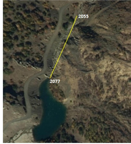
řekil 8. HGM Küre uydu görüntüsünden heyelan göl önündeki setin yükseklięi / Figure 8. The height of the dam in front of the landslide dammed lake from HGM Küre satellite image
