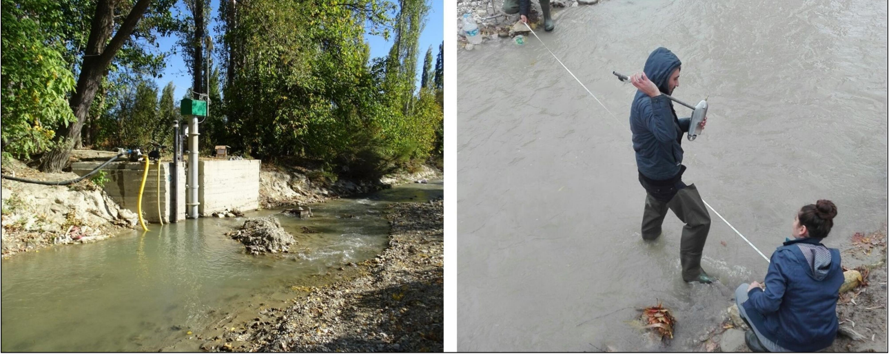
Şekil 3: Su seviyesi, akım ve sediman ölçüm istasyonundan ve eriyik sediman örnekleme aşamasından bir görünüm
