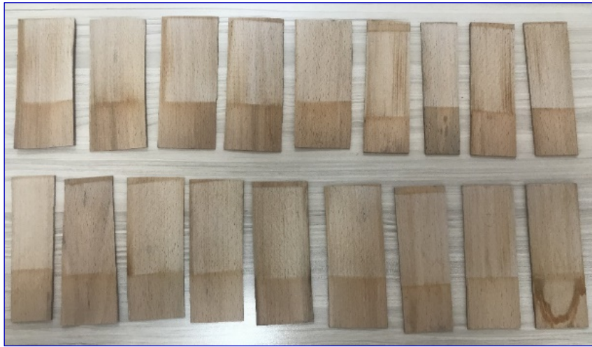
Şekil 3. Örneklerin 500 saat UV yaşlandırma testi sonrasındaki görünümü.
