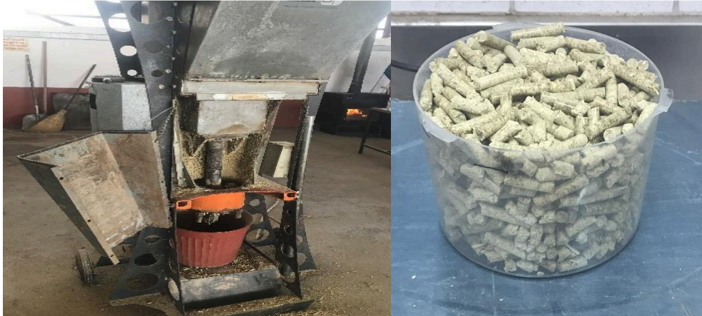
Figure 4. Pelleting machine and produced pellets Şekil 4. Pelet makinası ve üretilen peletler
