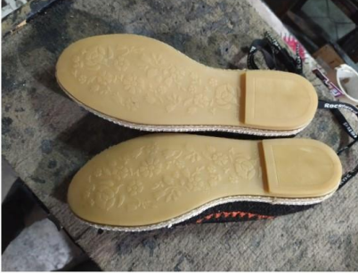
(Foto. 28 Tabanın yapıştırılması.)
