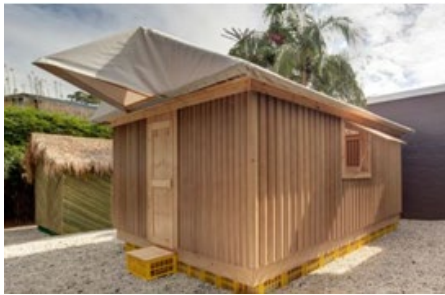
Şekil 7 a. Karton tüp kullanılmış geçici afet barınağı
