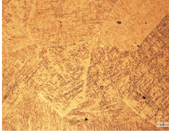
Şekil 3. Kaynak metal mikroyapısı
