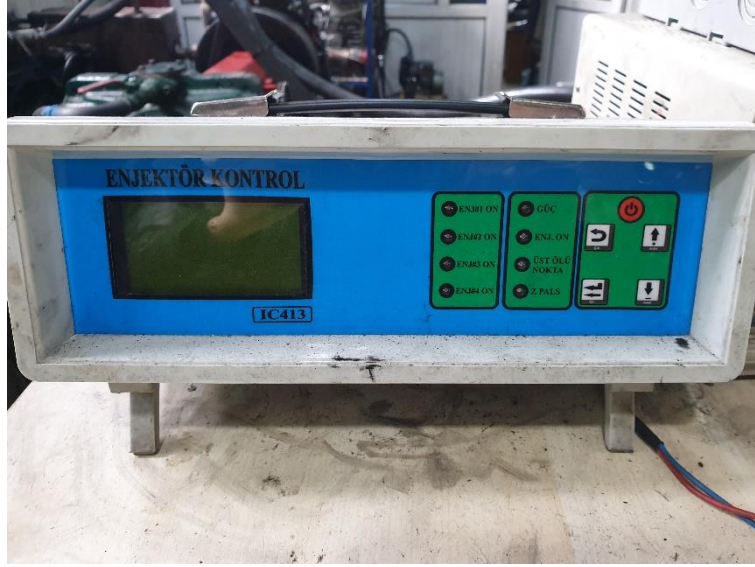
Şekil 2. Enjektör Kontrol Paneli
