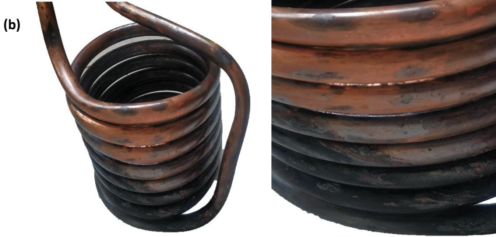
Şekil 6. 21 gün boyunca farklı ortamlarda korozyona maruz bırakılmış bakır serpantinler; (a) SCW, (b) SCW+NaNO 2
