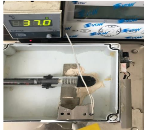
Resim 1. Statik model döngüsel yorgunluk test düzeneğinde metal yapay kanal içeren bloğun monte edildiği plastik kap, termokaplı ve ortamın sıcaklığını ölçen ve ayarlayan termostat izlenmektedir.
