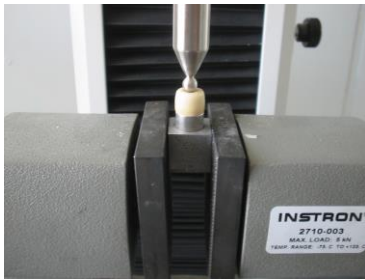
Şekil 3. Instron Universal Test Cihazında kırılma direnci testi
