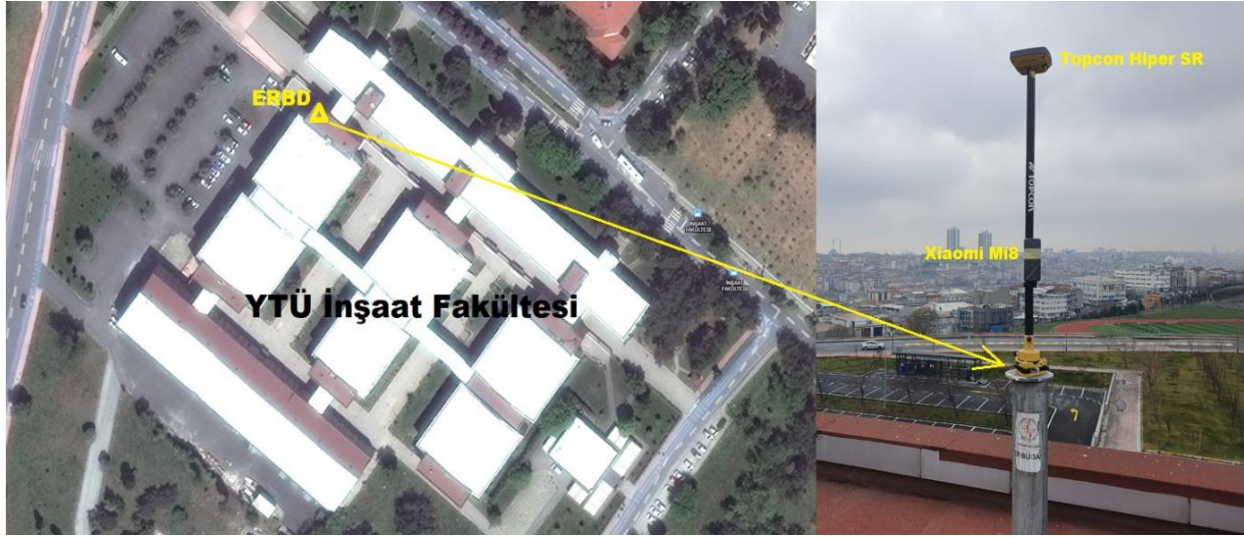
Şekil 1: ERBD test noktasında Topcon Hiper SR ve Xiaomi Mi8 akıllı telefonun eş zamanlı statik GNSS ölçümü
