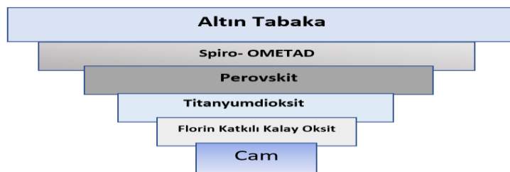
Şekil 2. Perovskit güneş hücrelerinin katmanlı yapısı [34].
