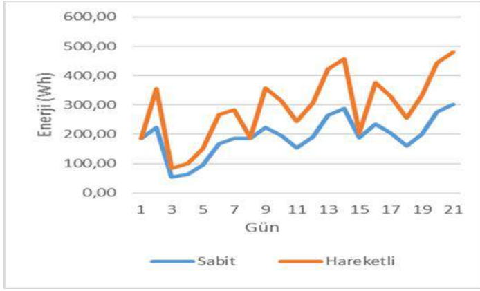
Şekil 5. LilyPad Işık Sensörlü sistemin hareketli ve sabit konumdaki enerji üretimi
