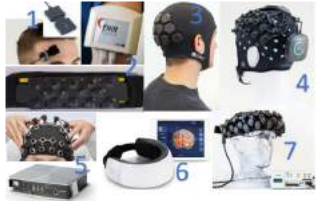
Şekil 4. Örnek portatif fNIRS sistemleri. Artinis Portalite † (1), Biopac fNIR Devices 2000M ‡ ve alın üzerine yerleştirilen sensör pad (2), GowerLabs LUMO § (3), Artinis Brite MKII ** (4), Shimadzu LIGHTNIRS †† (5), Soterix OBELAB NIRSIT ** (6), Hitachi/NeU WOT-HS §§ (7).
