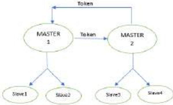
Şekil.9 Token Passing ve Master-Slave Çalışma prensibi
