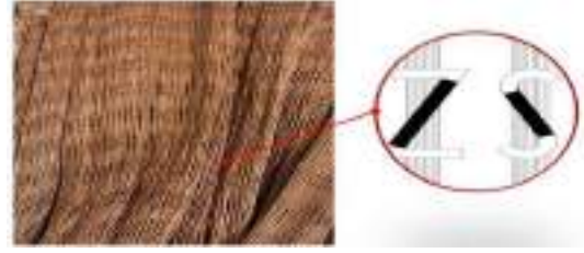
Şekil 2. Kord ipi büküm yönü şekilleri
