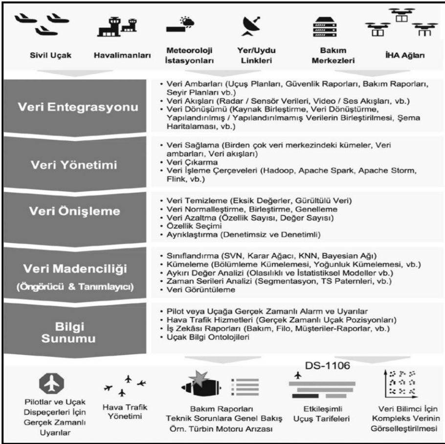
Şekil 5. Sivil Havacılık Sektöründe Büyük Veri Teknolojisinin Güvenli ve Verimli Uçuş Süreçlerine Katkısı (Kaynak: Çukur, 2020, s.19)
